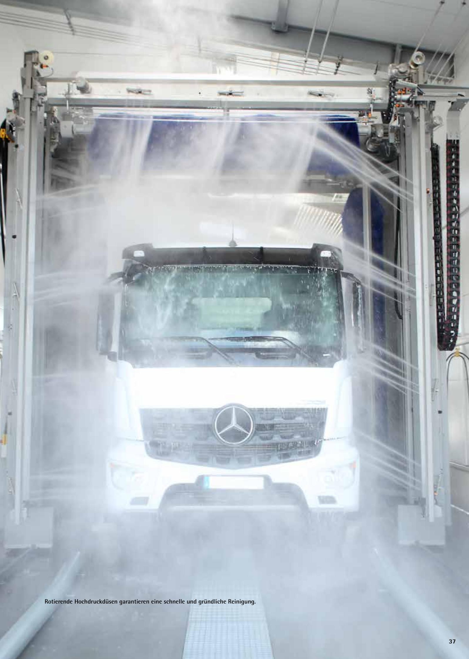
Rotierende Hochdruckdüsen garantieren eine schnelle und gründliche Reinigung.
