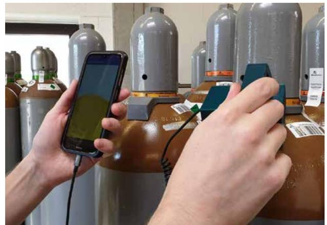
Das Projekt Smart Track entwickelt Funkchips und Scanner, mit denen Gasflaschen automatisch verfolgt und überwacht werden können.
