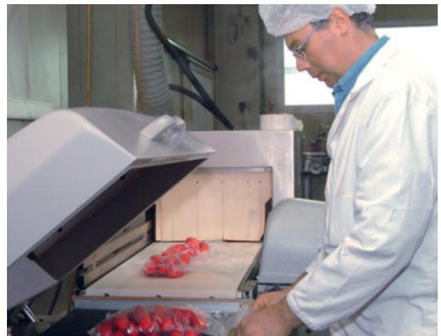
Bei Fleisch- und Wurstwaren bewährt: Evakuieren und Rückbegasung mit Protadur® Schutzgas.
