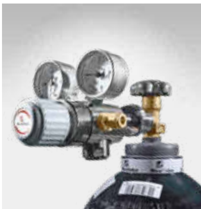
Druckregler WEGA 2, zweistufig, für Stickstoff, Regelbereich 1 bis 10 bar, mit 8 mm Klemmringverschraubung.
