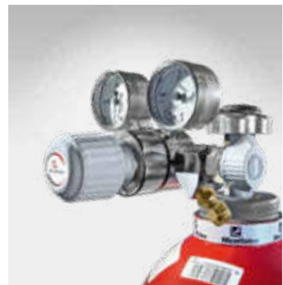
Druckregler WEGA 1, einstufig, für brennbare Gase, Regelbereich 1 bis 10 bar, mit Membranabsperrventil, 6 mm Klemmringverschraubung.
