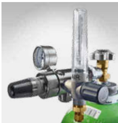
Druckregler WEGA 2, zweistufig, mit Mengemesser und Dosierventil, 8 mm Klemmringverschraubung.
