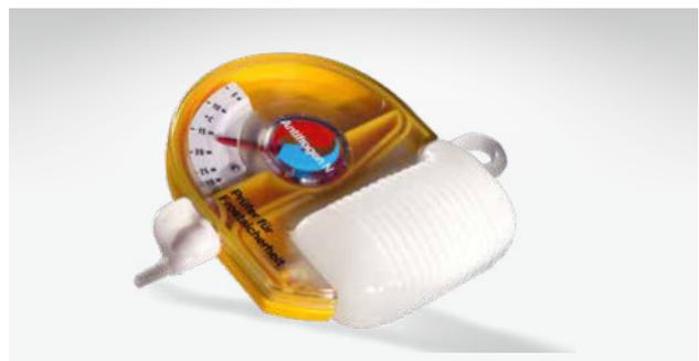
Frostschutzprüfer für Antifrogen® N-Wärmeträger.
